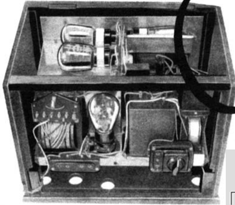
Die Schaltung der Niederfrequenzstufe.
